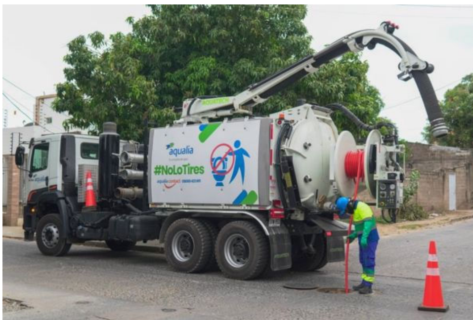
El nuevo vehículo de succión-presión incorporado por Aqualia permitirá realizar labores especializadas de limpieza y mantenimiento en las redes de alcantarillado sanitario de Riohacha.
